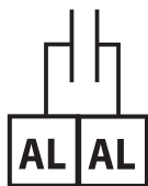
CONTACTO REMOTO DE ALARMA
